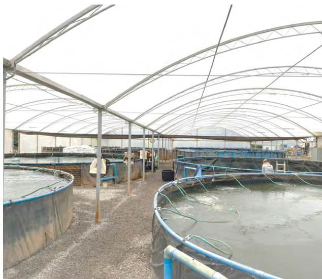
Fotos 3 e 4. Tanques para alevingem em Sistema 100% RAS, água clara, com Biofiltro e mídias MBBR para nitrificação.– alta produtividade e máxima biosseguridade. RAS Genomar, Guapé/MG., 2026.
