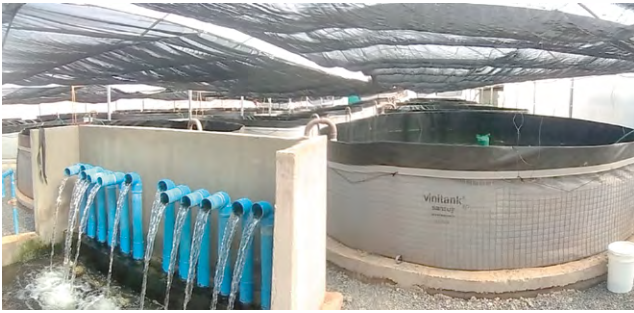
Foto 2. Sistema RAS com alta biosseguridade para produção de alevinos. Genomar – Guapé/MG. Projeto Altamar Sistema Aquáticos. 2025.
