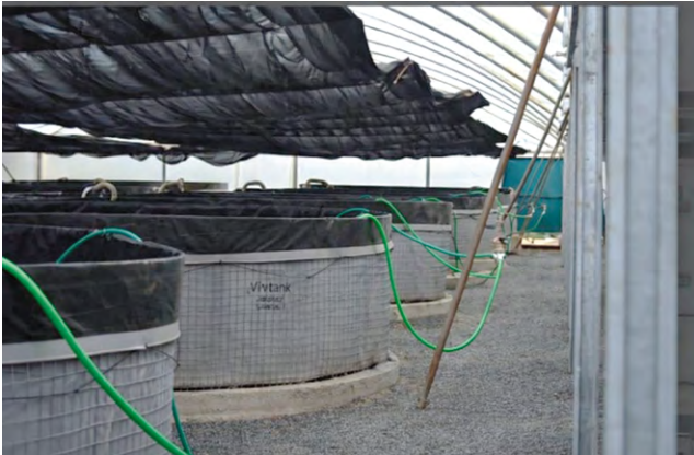
Foto 2. Sistema RAS com alta biosseguridade para produção de alevinos. Genomar – Guapé/MG. Projeto Altamar Sistema Aquáticos. 2025.
