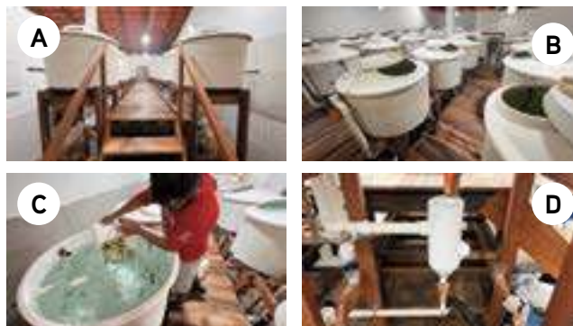
FIGURA 3. Novo sistema de digestibilidade de ingredientes/rações para camarões do LABOMAR. A , vista panorâmica dos tanques; B , vista superior; C , povoamento de camarões; D , decantador para coleta de fezes e ração não consumida.
