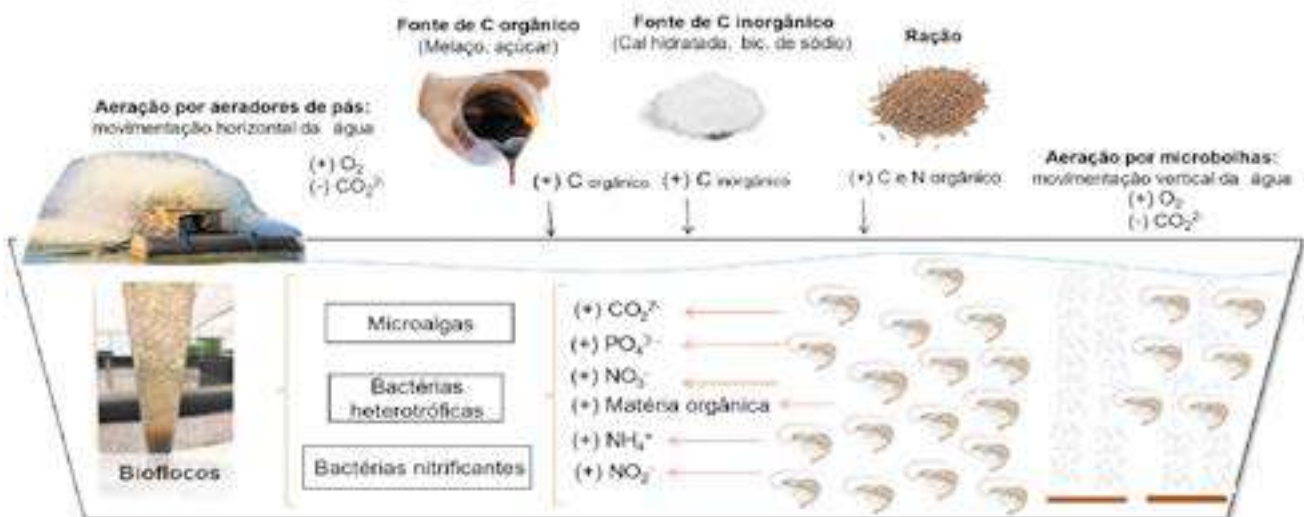
Figura 4. Esquema com fluxo de nutrientes, as fontes de C e N e as vias metabólicas no sistema Bioflocos.
