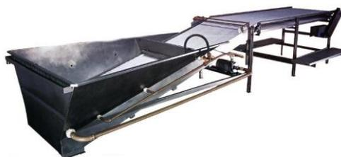
**Figura 11. Retirada dos camarões com o equipamento para virar, ou tombar, bins no separador de gelo (Esq). Imagem de um separador de gelo com esteira para seleção (Acima) (Fotos: Rodrigo Carvalho, Brusinox)**
