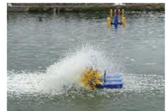
Como as diatomáceas produzem muito oxigênio durante o dia, realizamos um experimento comparando o que acontece com o OD do viveiro com aeradores de pás tradicionais versus um novo tipo de aerador “Ripple®”. Os aeradores de pás são normalmente de 1,5 kW e 8 deles ou cerca de 12 kW podem manter um viveiro de 4.000 m<sup>2</sup> com uma densidade de aproximadamente 100 unidades/m<sup>2</sup> de *L. vannamei* e metade disso para *monodon*.
