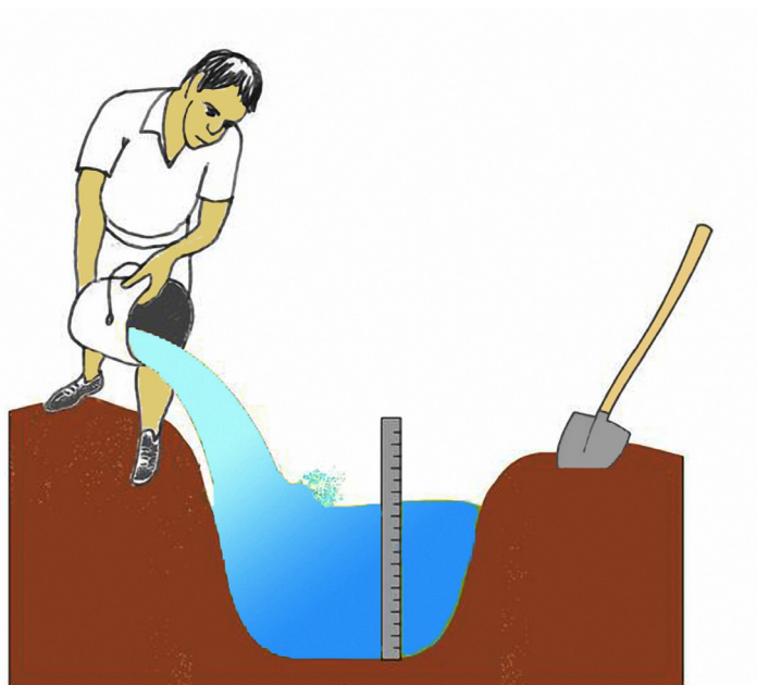
Figura 9. Teste de infiltração de água através do uso de uma vala. O fundo deve estar no mesmo nível que a cota do fundo dos viveiros que serão construídos.
