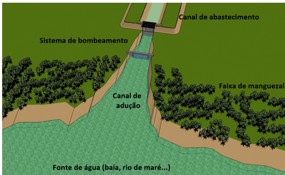
Figura 19. Canal de adução escavado entre a fonte de água e a estação de bombeamento. Em muitos casos, esta é a única porção de Área de Proteção Permanente diretamente afetada pela instalação de uma fazenda.
