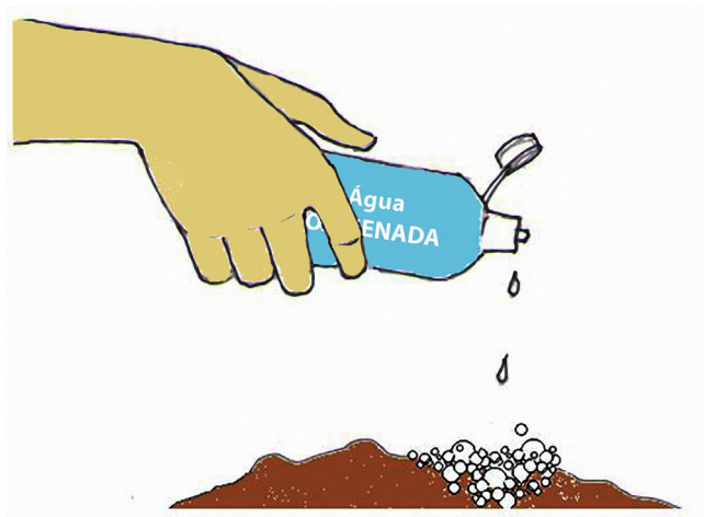
Figura 16. Uso de água oxigenada para identificar solos excessivamente sulfurosos.
