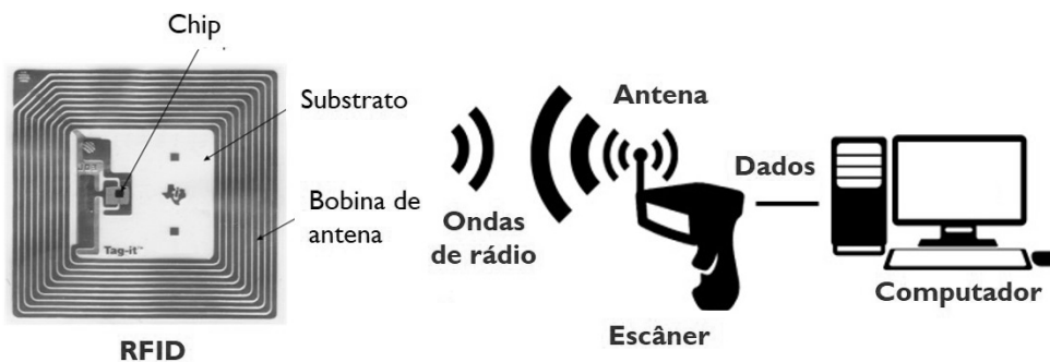
Figura 71. Princípio básico de funcionamento do sistema RFID.
