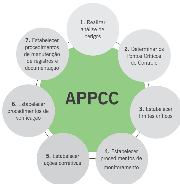
Figura 79. Etapas para a implantação do sistema de Análises de Perigo e Pontos Críticos de Controle (APPCC).
