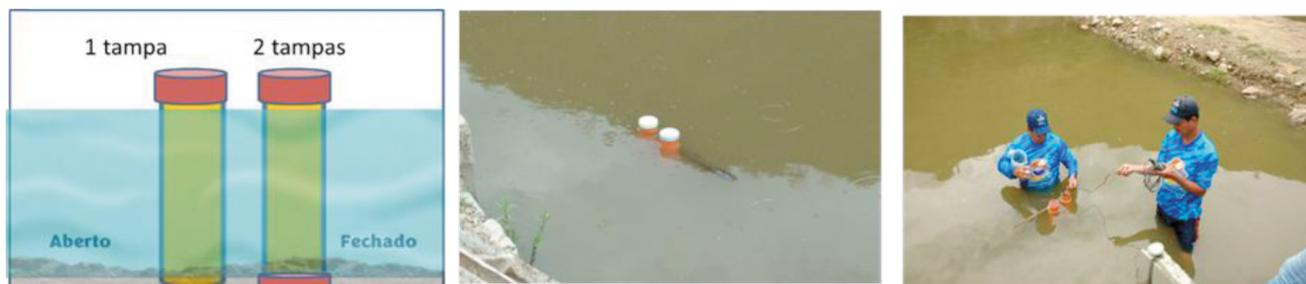
**Figura 5.** Metodologia para encontrar a demanda de oxigênio dissolvido num viveiro de camarão conhecida como Tubos de respirometria. **A)** Esquema dos tubos, tubo Aberto, só com uma tampa no extremo superior; e o tubo Fechado, com tampas em ambos os extremos. **B)** Posição vertical e praticamente ao nível da superfície da água. **C)** Medição do oxigênio dissolvido antes e após o tempo de finalizado o teste de respiração.
