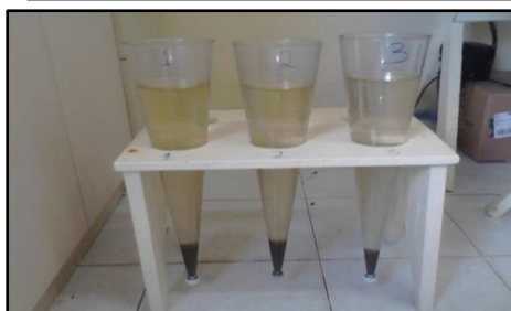
Fotos 44 e 45 – Esquema ilustrativo com cones Imhoff sendo utilizados para mensurar os sólidos sedimentáveis Fonte: SCOPEL, Bruno - 2013.
