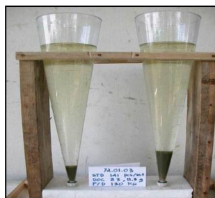
Fotos 44 e 45 – Esquema ilustrativo com cones Imhoff sendo utilizados para mensurar os sólidos sedimentáveis Fonte: SCOPEL, Bruno - 2013.
