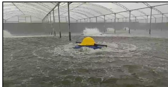
Foto 106 – Aeração horizontal e circular com aeradores de ondas “ wave maker ” em viveiros intensivos Fonte: MCR Aquacultura - 2020.
