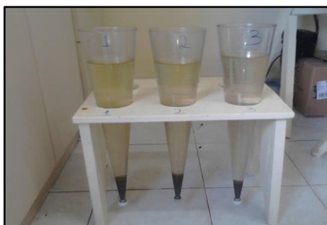
Fotos 44 e 45 – Esquema ilustrativo com cones Imhoff sendo utilizados para mensurar os sólidos sedimentáveis Fonte: SCOPEL, Bruno - 2013.
