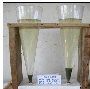
Fotos 44 e 45 – Esquema ilustrativo com cones Imhoff sendo utilizados para mensurar os sólidos sedimentáveis Fonte: SCOPEL, Bruno - 2013.
