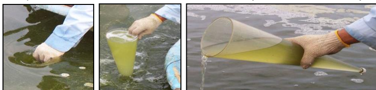
Fotos 44 e 45 – Esquema ilustrativo com cones Imhoff sendo utilizados para mensurar os sólidos sedimentáveis Fonte: SCOPEL, Bruno - 2013.
