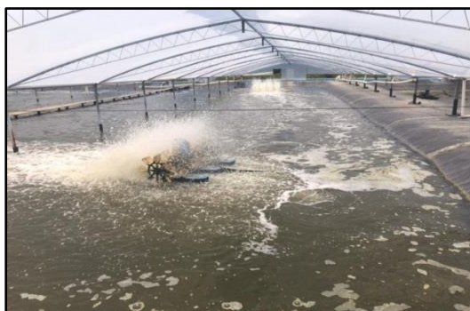
Foto 38 – Aeração consorciada com o uso de mangueiras porosas e aeradores de palhetas Fonte: MCR Aquacultura Ltda. - 2020.
