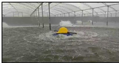
Foto 100 – Aeração horizontal e circular com aeradores de ondas “wave maker” em viveiros intensivos Fonte: MCR Aquacultura - 2020.
