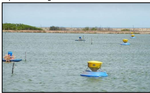
Foto 84 – Alimentador automático em viveiros abertos- Fonte: https://panoramadaaquicultura.com.br/wp-content/uploads/2019/04/171 .
