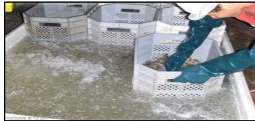
Fotos 124 e 125 – Despesca de camarão e choque térmico para o abate em água com gelo e metabissulfito de sódio- Fonte: MCR Aquacultura Ltda.
