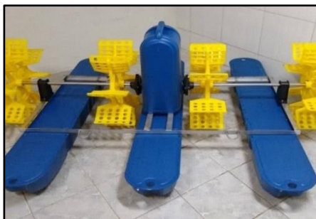
Fotos 34 e 35 – Aeradores de palheta (Paddle Wheel) e de ondas (Wave Maker) - Fonte: MCR Aquacultura Ltda. - 2020.
