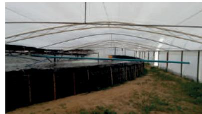
**SUNCOVER WHITE** (leitoso), filme plástico que diminui em 40% a 50% a entrada da radiação solar incidente. Recomendado para regiões e projetos que necessitam desacelerar o aquecimento da água durante o dia.
