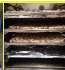
Figura 2. Secagem em estufa ( $60^\circ\text{C}$ ) com circulação de ar - ideal pesar antes e depois para cálculo do rendimento.
