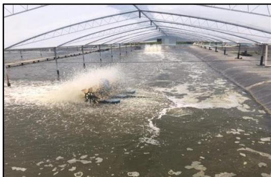
**Foto 38 – Aeração consorciada com o uso de mangueiras porosas e aeradores de palhetas**
