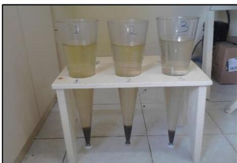
**Foto 46 – Cones Imhoff utilizados para mensurar os sólidos sedimentáveis**
