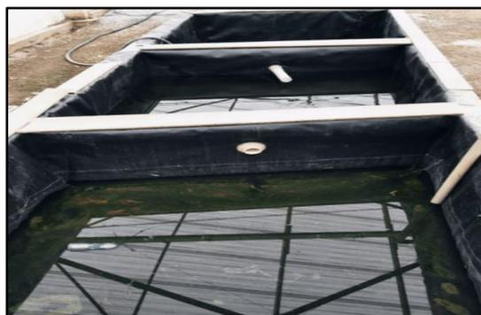
**Foto 48 – Tanque de decantação usado para tratamento de água em berçários primários e secundários**
