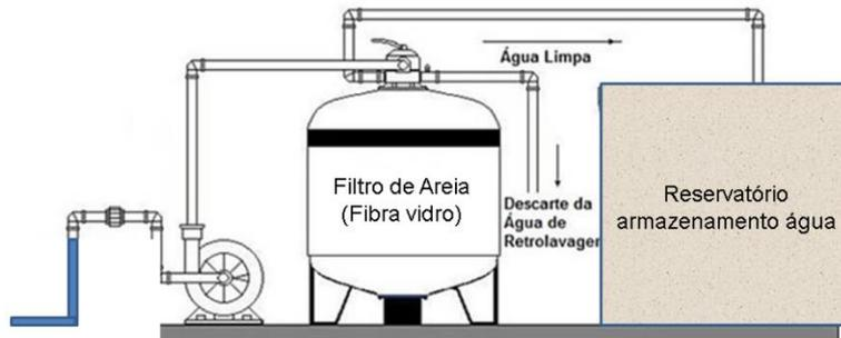
**Figura 22 – Esquema ilustrativo de tratamento de água com filtro de areia**
