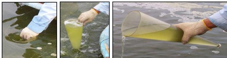
**Fotos 44 e 45 – Esquema ilustrativo com cones Imhoff sendo utilizados para mensurar os sólidos sedimentáveis**
