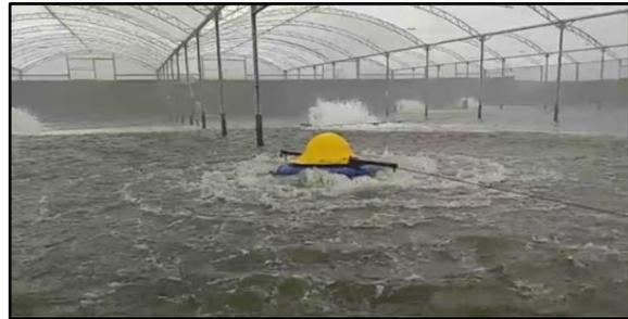
Foto 106 – Aeração horizontal e circular com aeradores de ondas “*wave maker*” em viveiros intensivos
