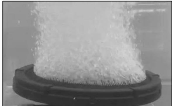
Foto 32 – Disco com membrana para aeração em tanques berçários
