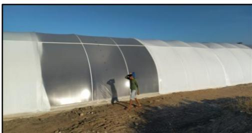
**Foto 42 – Tanques berçários secundários com uso de estufas para controle de temperatura**
