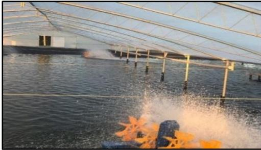
Foto 105 – Aeração horizontal com aeradores do tipo “*Paddle Wheel*” em viveiros intensivos
