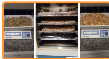
Secagem em estufa (60°C) com circulação de ar – ideal pesar antes e depois para cálculo do rendimento (Cortesia: Josué dos Santos Junior)
