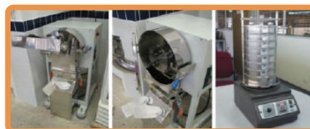
Moagem em moinho bola e facas, e tamisação – ideal pesar antes e depois da moagem para cálculo do rendimento (Cortesia: Josué dos Santos Junior)
