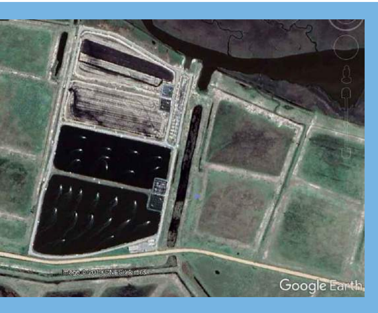
Figura 2. Fazenda Costa Azul, localizada em Campos Verdes (Laguna/SC), retomando a produção de camarões marinhos após anos em inatividade. A imagem mostra dois viveiros com água e aeradores ligados e outros dois viveiros já despescados (mais acima). Ao lado direito de cada viveiro (nos cantos), os berçários intensivos construídos para pré-engorda de juvenis de Litopenaeus vannamei (imagem: Google Earth).
