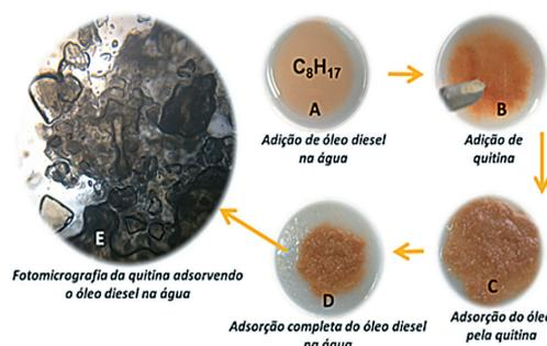
Foto 2. Adsorção do óleo diesel na água pela quitina nas placas de petri e uma fotomicrografia dos flocos de quitina adsorvendo o óleo diesel na água, aumentado 140 vezes
