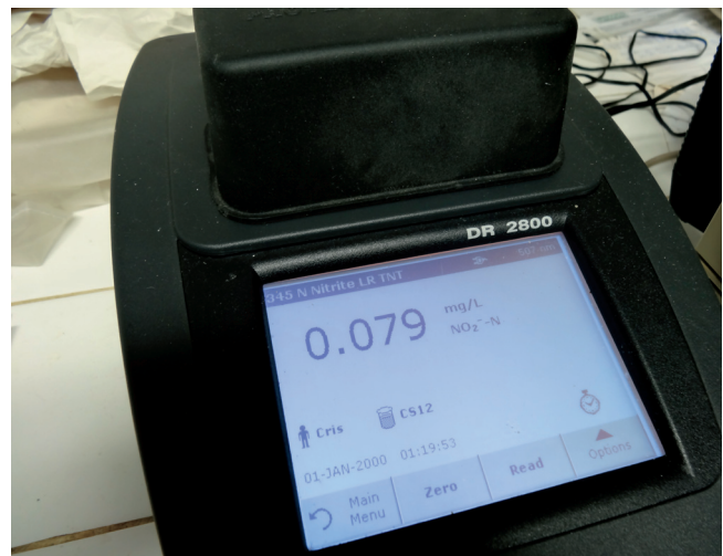
Figura 4. Monitoramento dos compostos nitrogenados da água de cultivo, utilizando um espectrofotômetro visível para uma leitura rápida e acurada.
