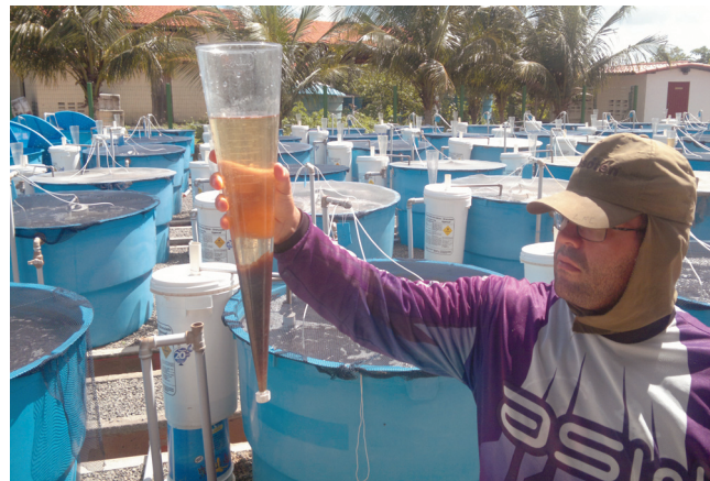
Figura 6. Cones de Imhoff empregados para medir a concentração de sólidos sedimentáveis na água de cultivo.
