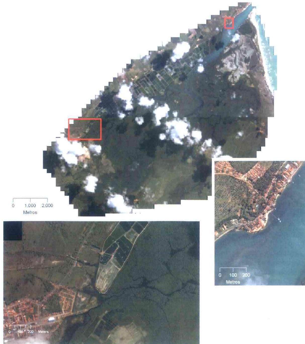
**Figura 15** – Extrato de uma imagem Ikonos de composição RGB com resolução espacial de 1,0 metro. Rio Curimataú, extremo sul do Rio Grande do Norte, 2003. Detalhes da resolução deste produto onde é possível observar os aeradores nos viveiros de camarão na ampliação mais à esquerda, e o píer com duas embarcações à direita.
