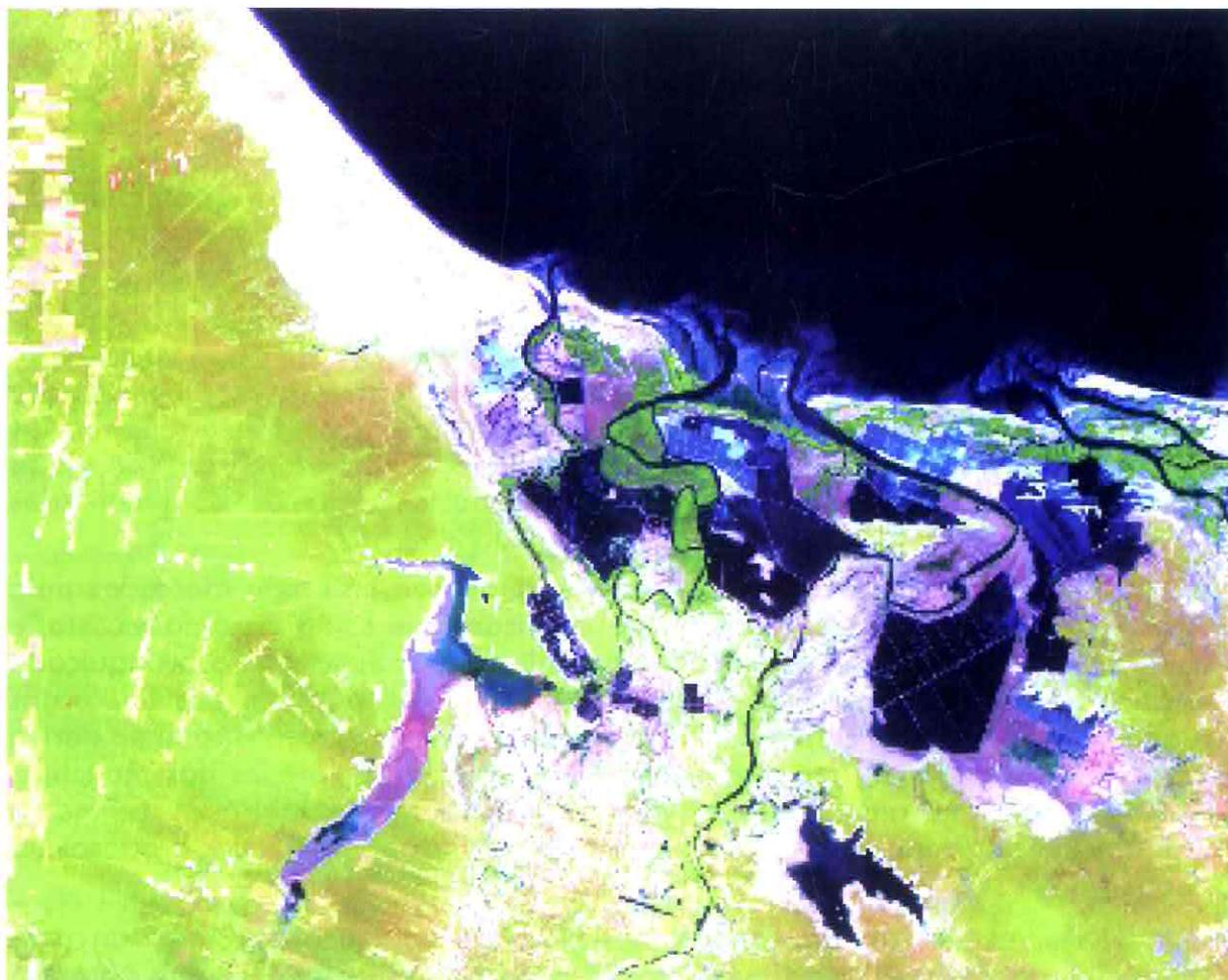
**Figura 12** – Composição RGB 543 do LANDSAT 7 ETM+ de 2001, Imagem da região de Macau-RN. As zonas alagadas têm resposta espectral em tons lilás a róseo.
