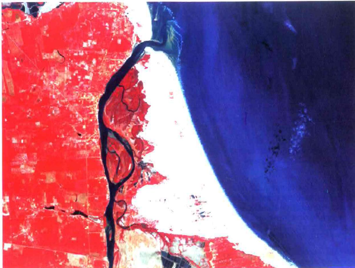
**Figura 11** – Composição RGB 432 do LANDSAT 7 ETM+ (agosto de 2002), Imagem da desembocadura do rio Jaguaribe-CE. Observar áreas de manguezais em tons de vermelho escuro na margem direita do rio.
