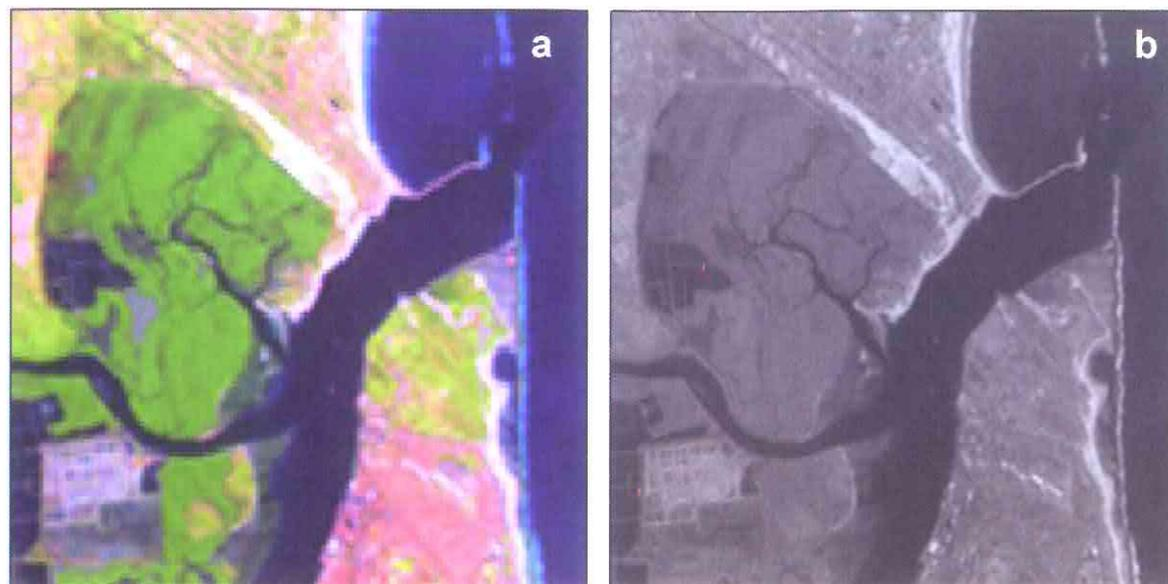
**Figura 14** – Foz do rio Potengi no estado do Rio Grande do Norte, a) LANDSAT RGB 543 resolução espacial de 30 metros. b) LANDSAT Banda 8 resolução espacial de 15 metros, maior definição nos contornos das feições geográficas presentes nas imagens.
