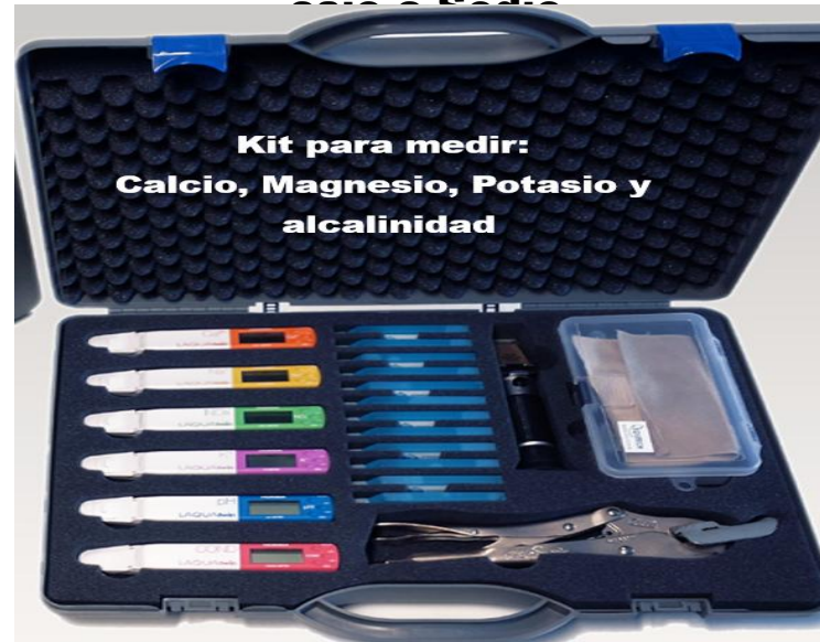
Kit para medir Alcalinidade, Potássio, Cálcio, Magnésio e Sódio
