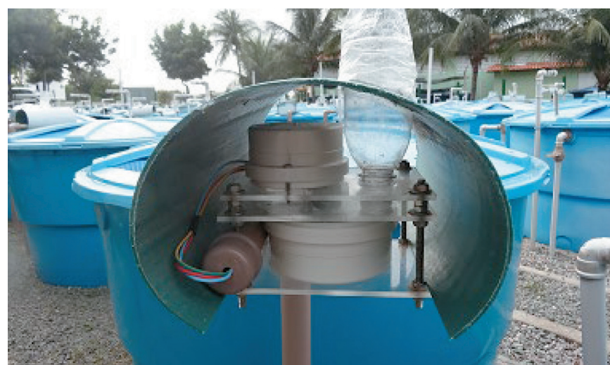
FIGURA 3 – A, alimentador mecânico desenvolvido no LABOMAR/UFC para alimentação dos camarões múltiplas vezes. Ilustração: Dr. Leandro Fonseca Castro. B, alimentador instalado
