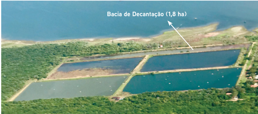
FIGURA 7 – Faz. Acquabrazilis, construída em 2001, portanto 18 anos atrás, e a primeira do Piauí construída com bacia de decantação, que permite o reúso da água. Densidade de 55 cam/m 2 . Uso de alimentadores automáticos. Produtividade de até 4.211 kg/ha (março/2019).
