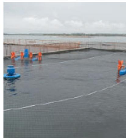
Figura 4 - Aeração em tanque rede.
