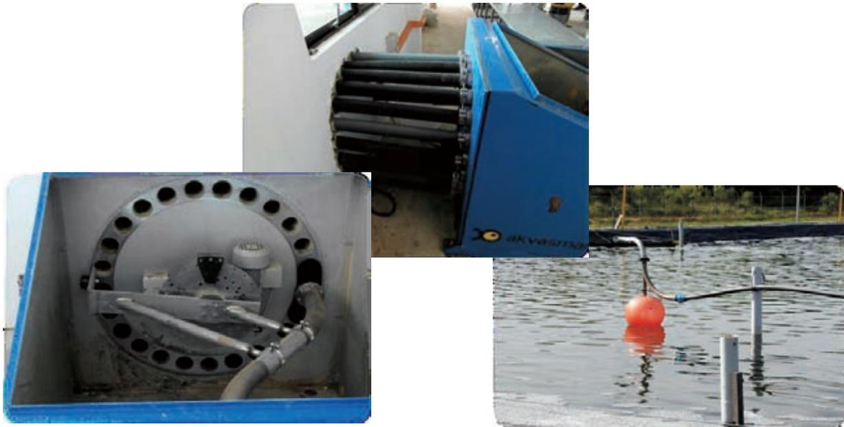
**Foto 92 a 94:** Alimentação de camarões com uso de alimentadores automáticos pneumáticos.
