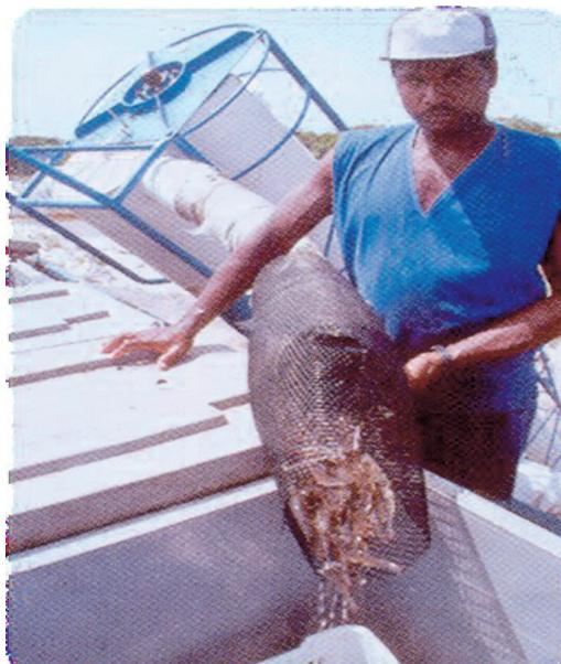
**Foto 125:** Saída do camarão na parte superior da máquina de despesca.
