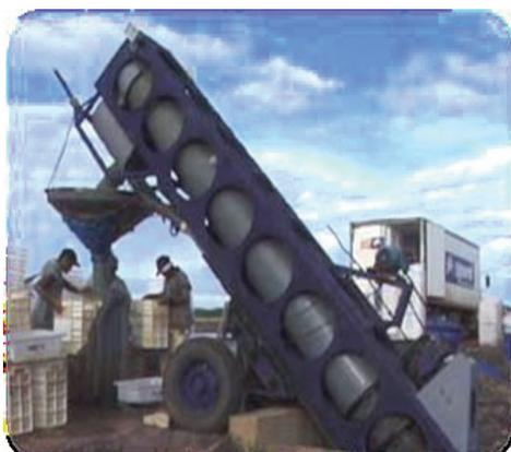
**Foto 124:** Máquina de despesca de camarões - elétrica.
