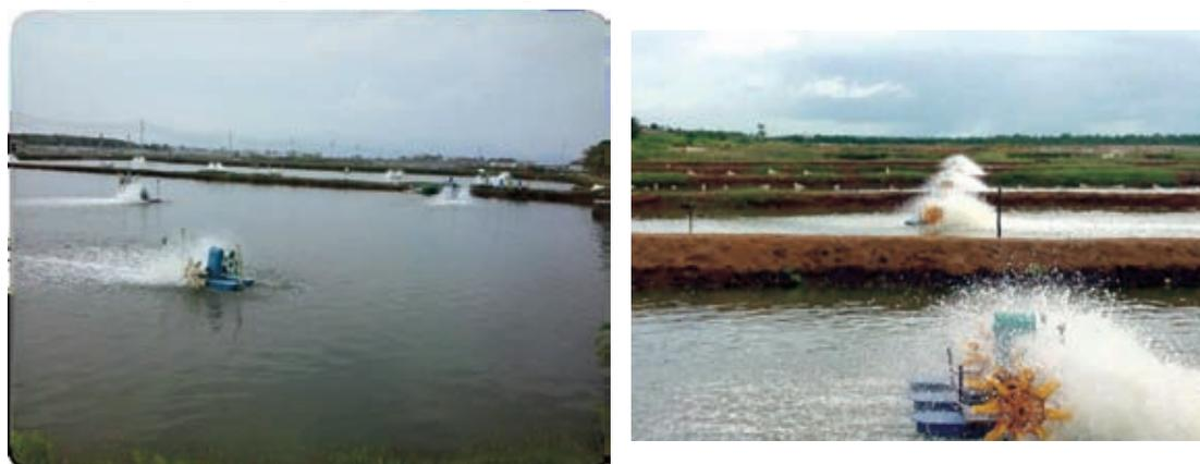
**Foto 68 e 69:** Aeração mecânica em viveiro.
