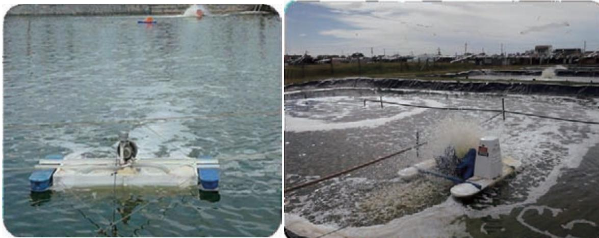
**Fotos 38 e 39:** Aeração consorciada com o uso de injetores flutuantes e aeradores de palhetas.
