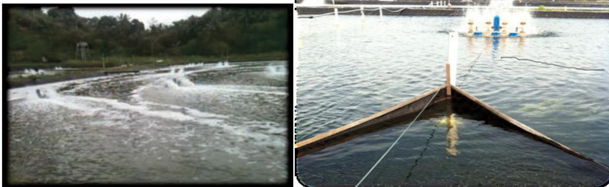
**Foto 102 e 103:** Posicionamento dos aeradores com vistas a direcionar a circulação da água em viveiros de camarão na Indonésia e em Brunei.
