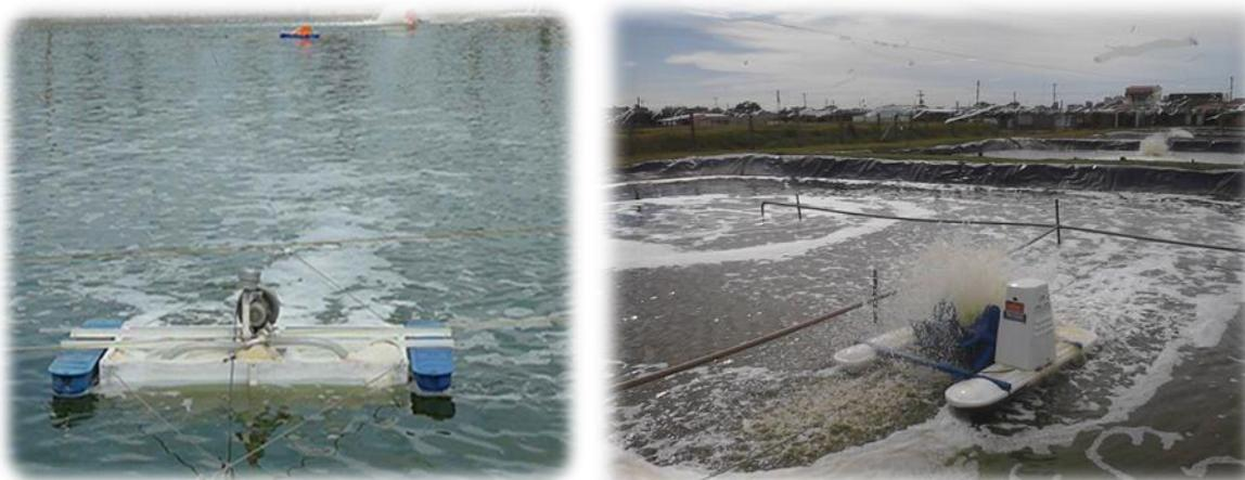
**Fotos 38 e 39:** Aeração consorciada com o uso de injetores flutuantes e aeradores de palhetas.
