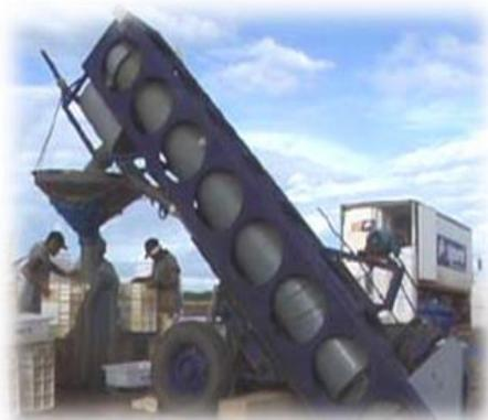
**Foto 124:** Máquina de despesca de camarões - elétrica.
