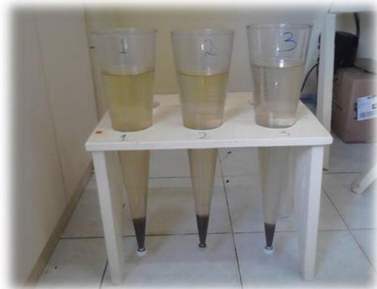
**Foto 50:** Cones Imhoff utilizados para mensurar os sólidos sedimentáveis.
