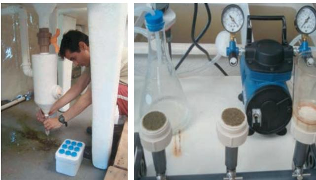
**Figura 5** – Coleta das amostras de fezes de camarão nas colunas de decantação e filtragem das fezes através de um sistema de filtração à vácuo
