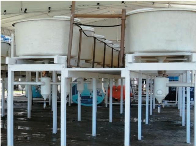
**Figura 4** – Tanques com coluna de decantação para estudos de digestibilidade com o camarão matinho *L. vannamei*. do Laboratório de Nutrição de Organismos Aquáticos da UFRN desenvolvido segundo Carvalho et al., 2013.
