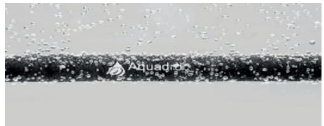
Figura 4 – Microbolhas transferidas pelo sistema de ar difuso composto por mangueiras porosas
