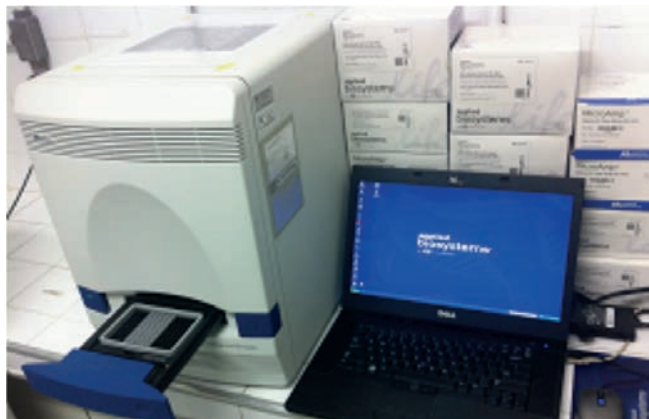
Figura 6 – Equipamento de qPCR em tempo real no Labomar/UFC.
