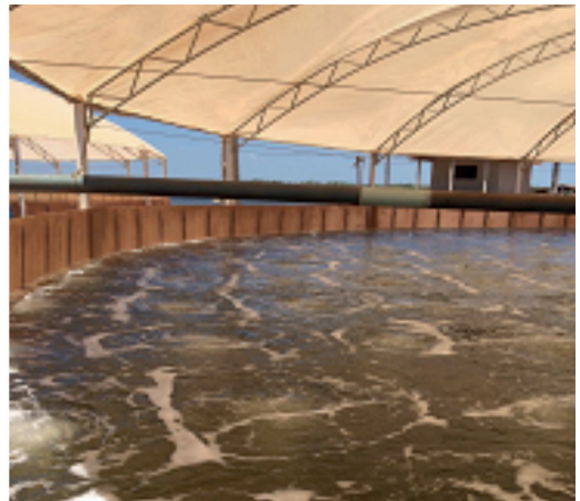
Figura 3 – Tanque raceway de camarão em Camocim (CE): aeração feita com microbolhas transferidas por mangueiras porosas
