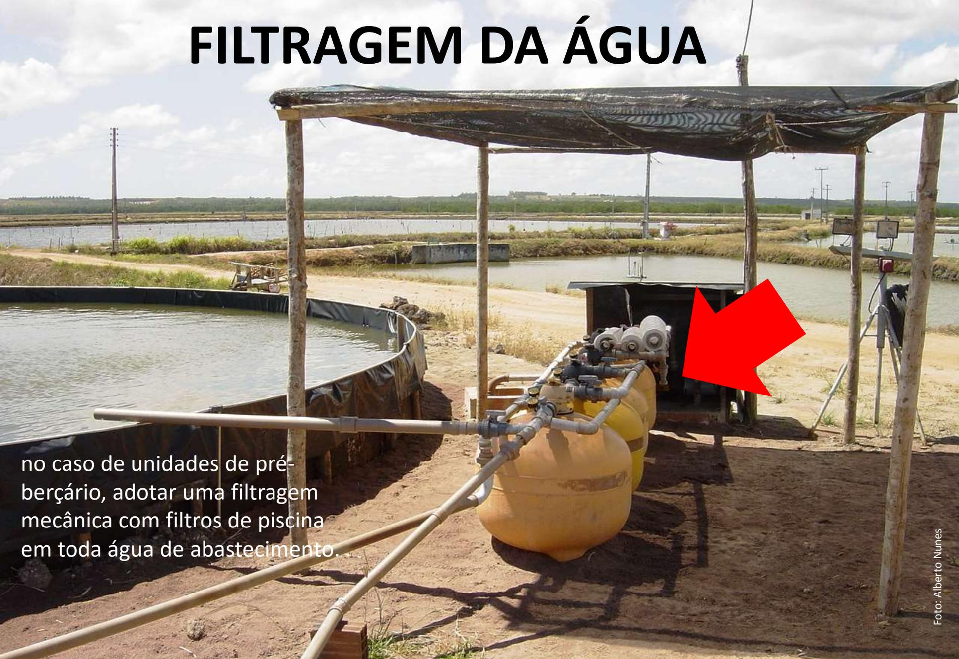
no caso de unidades de pré-berçário, adotar uma filtragem mecânica com filtros de piscina em toda água de abastecimento.
