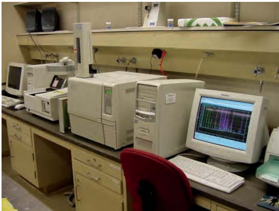
Cromatógrafo de gases y el latroscan, usados para determinar composición de lípidos en raciones.
