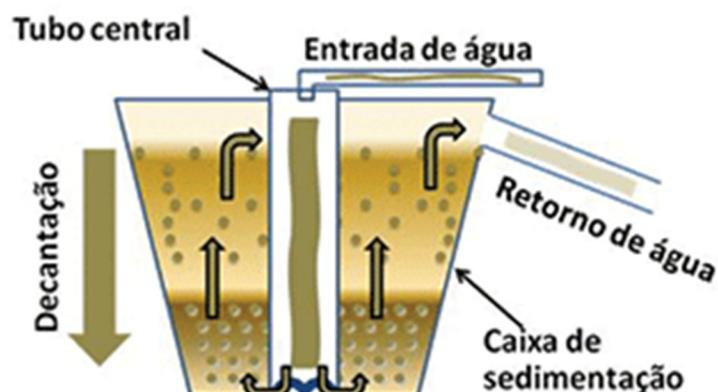
Ilustração referente à decantação de partículas durante o processo de clarificação, com acúmulo de material sedimentado no fundo da caixa de sedimentação. (FONTE: Revista Panorama da Aquicultura)
