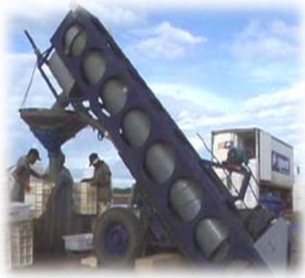
Foto 123: Máquina de despesca de camarões - elétrica. Fonte: MCR Aquacultura Ltda
