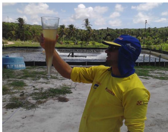
Foto 51: Uso de sedimentadores em berçários. Fonte: SCOPEL, Bruno, 2013; LCM-UFSC, 2012.
