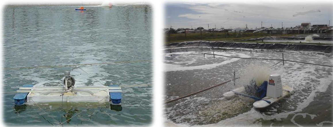
Fotos 38 e 39: Aeração consorciada com o uso de injetores flutuantes e aeradores de palhetas. Fonte: coloriteaerationtubing.com – 2013; FURG, 2012.
