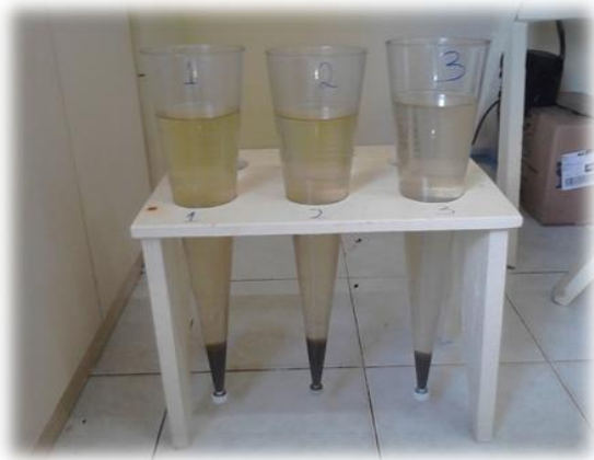
Foto 50: Cones Imhoff utilizados para mensurar os sólidos sedimentáveis. Fonte: SCOPEL, Bruno - 2013.
