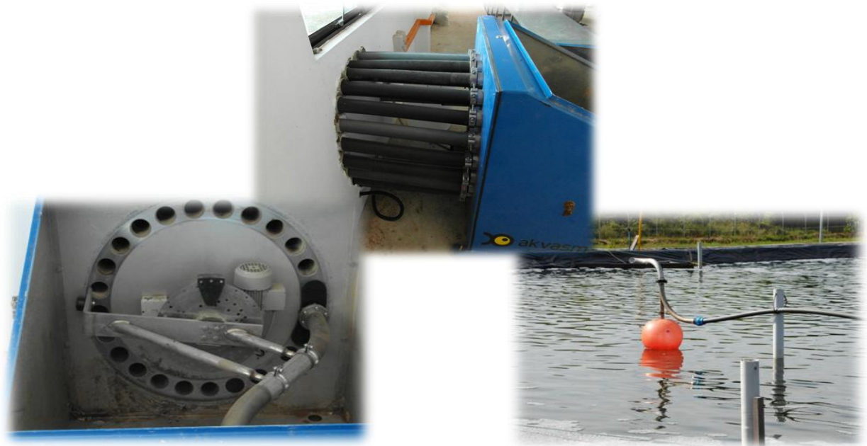
Fotos 91 a 93: Alimentação de camarões com uso de alimentadores automáticos pneumáticos. Fonte: ABCC – Visita técnica Carcinicultura Brunei - 2012.
